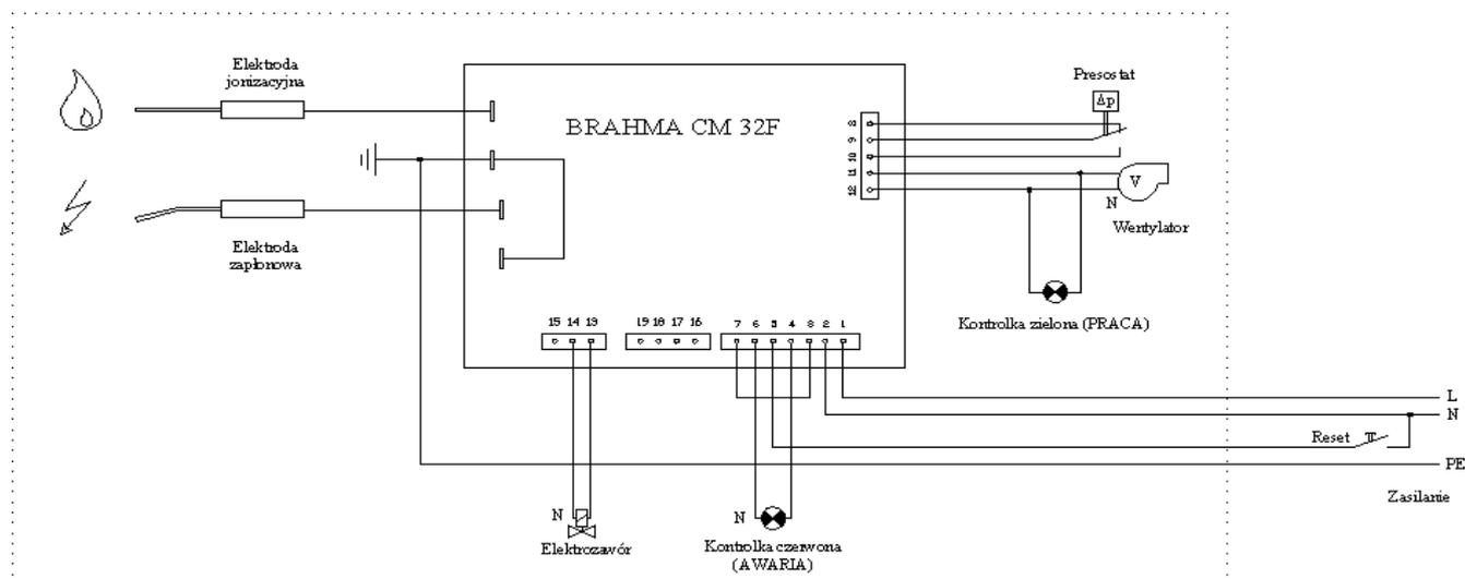
Рис. 24. Электрическая схема излучателя SBT
