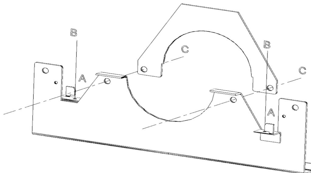
Рис. 6. Кронштейн для крепления излучателя SBT в версии "I".
