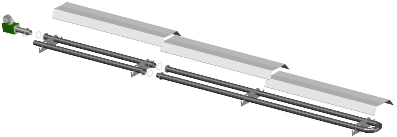
Рис. 18. Монтаж зеркал (экранов) излучателя.
