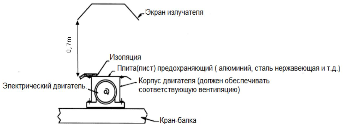
Рис. 15. Примерный способ изоляции двигателя кран-балки
