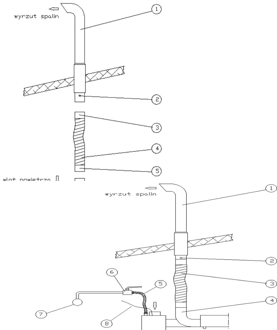
Рис. 21. Схема отвода отработанных газов.
