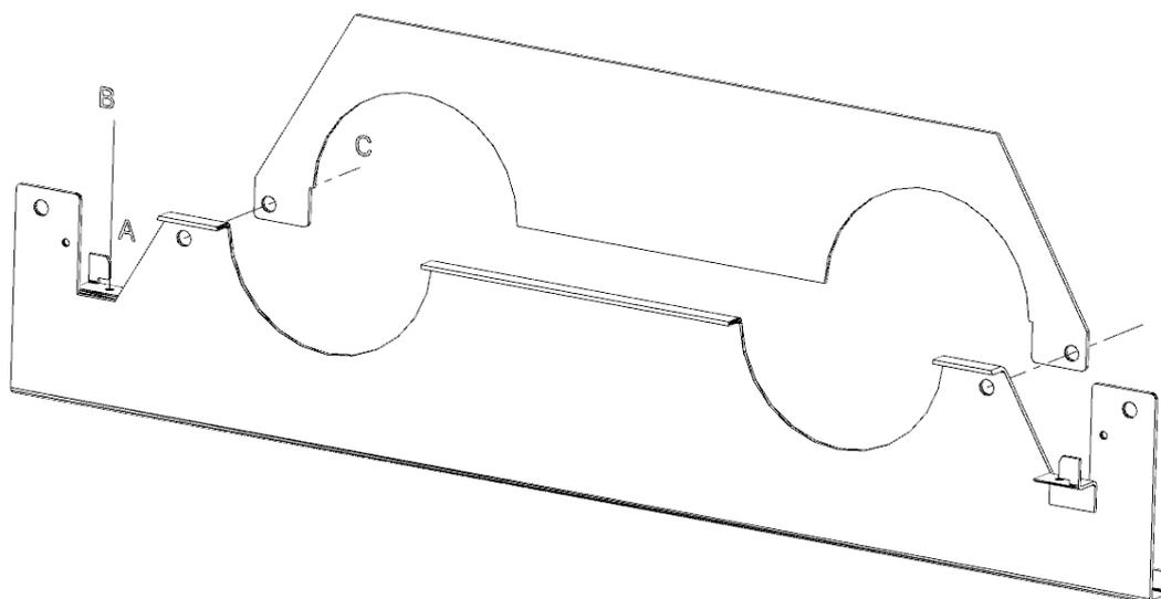
Рис. 5. Постоянный кронштейн для крепления излучателя SBT в версии "U"
