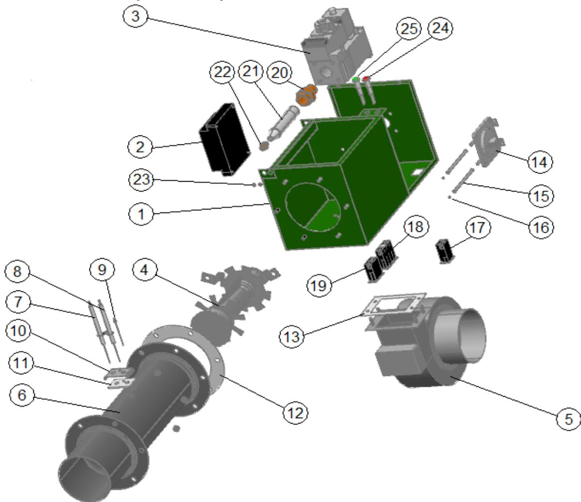
Рис. 10. Вид компонентов горелки SBT.
