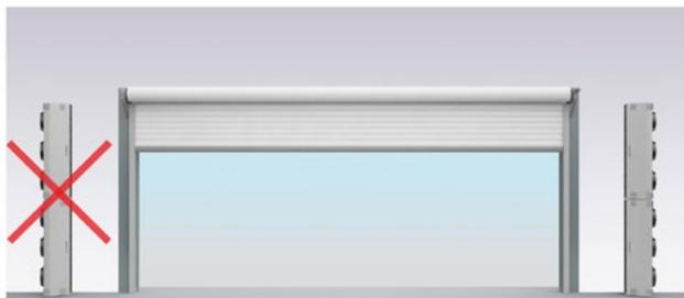
Для правильной работы завесы необходимо перекрыть всю поверхность дверного проема. Завесы ELiS G приспособлены к соединению между собой, благодаря чему можно полностью перекрыть дверной проем. Неправильная установка может приводить к тепловым потерям в зимний период, а также к потерям холодного воздуха в кондиционируемом помещении летом.
